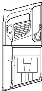
2. Positionnez le récipient à poussière au-dessus d'une poubelle et faites glisser le CleanTouch™ Dirt Ejector (éjecteur de saletés CleanTouch™) vers l'avant.
