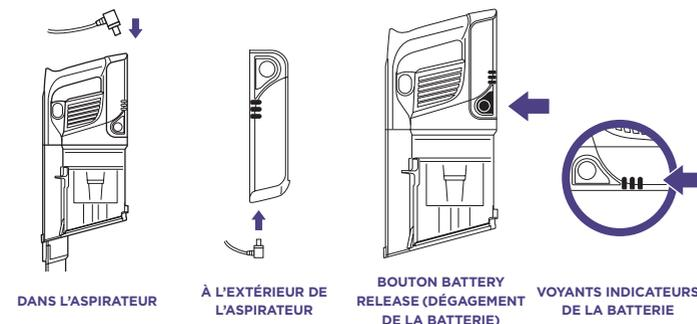
Insérez ou retirez facilement la batterie au lithium-ion
