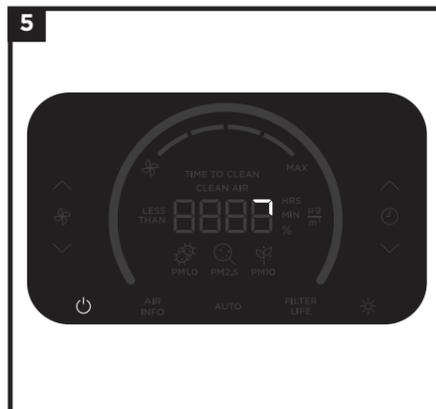
Le purificateur d'air commencera à mesurer la qualité de l'air dans la pièce, indiquée par les lumières rotatives. Après quelques secondes, l'appareil affichera la qualité de l'air actuelle.
