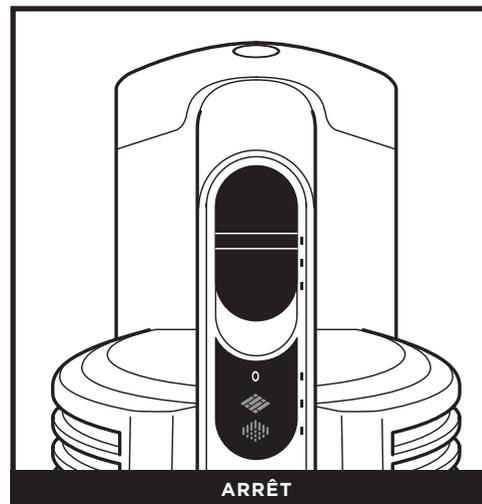
Faites glisser l'interrupteur vers le bas pour couper l'alimentation. Pour utiliser l'aspirateur en **mode standard**, glissez l'interrupteur au réglage souhaité.
