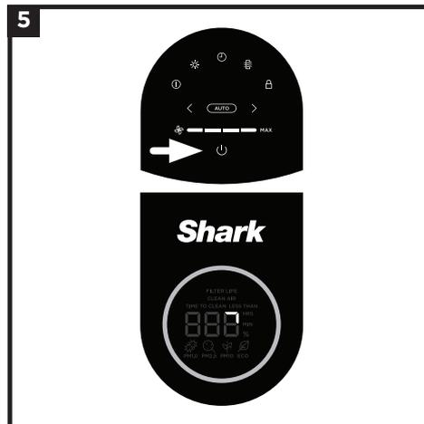
5. Branchez l'appareil sur une prise électrique et appuyez sur le bouton d'alimentation situé sur le panneau de commande supérieur ou sur la télécommande. Lorsque l'appareil est sous tension, il commence à analyser la qualité de l'air indiquée au moyen de voyants rotatifs. Après quelques secondes, l'appareil affichera la qualité de l'air actuelle.
