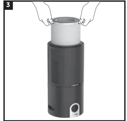
3. Une fois le filtre réinstallé, tournez la porte du filtre jusqu'à ce qu'elle s'enclenche en place.
