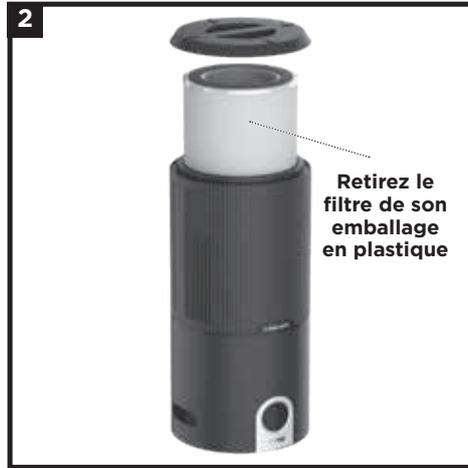
2. Sortez le filtre de son emballage, puis insérez-le dans l'appareil. **NE FAITES PAS** fonctionner le purificateur d'air avant d'avoir retiré le filtre de son emballage et de l'avoir installé correctement. Une fois le filtre réinstallé, tournez la porte du filtre jusqu'à ce qu'elle s'enclenche en place.
