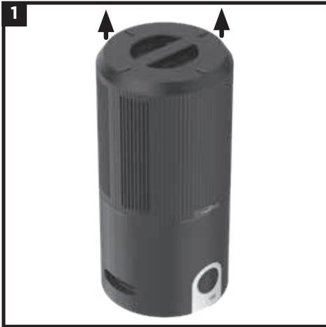
1. Tout d'abord, retournez délicatement le purificateur d'air et placez-le sur une surface plane. Tournez la porte du filtre pour déverrouiller le filtre.
