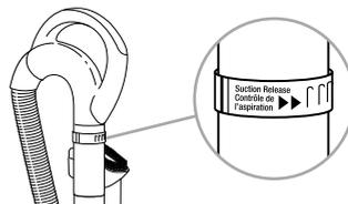
La succion de votre aspirateur est très puissante. Il est possible de régler la puissance d'aspiration pour faciliter les mouvements vers l'avant et vers l'arrière sur certains types de tapis.
