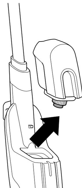
**1** Pour retirer le réservoir, soulevez-le et détachez-le du corps de la vadrouille à vapeur. Assurez-vous de débrancher la vadrouille à vapeur avant de retirer le réservoir d'eau.
