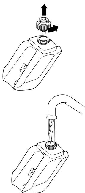
**2** Pour retirer le bouchon du réservoir d'eau, faites-le tourner dans le sens antihoraire. Remplissez entièrement le réservoir d'eau distillée ou d'eau du robinet.
