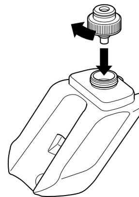
**3** Replacez le bouchon sur le réservoir d'eau et tournez-le dans le sens horaire pour le fermer.
