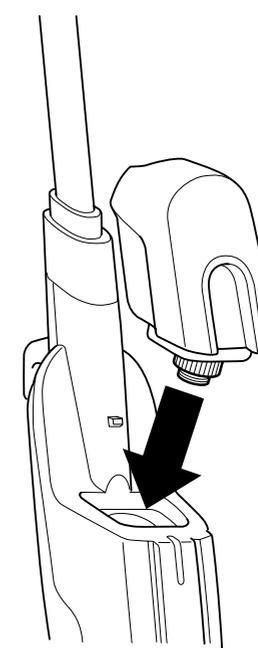
**4** Pour remplacer le réservoir d'eau, alignez-le de façon à ce que le bouchon soit orienté vers le bas. Placez le bouchon dans le trou du corps de la vadrouille à vapeur et faites glisser le réservoir vers le bas de manière à entendre un déclic indiquant qu'il est bien en place.
