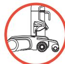
Lorsque l'aspirateur est placé en position verticale, les roues rétractables s'étendront de façon à ce que l'aspirateur puisse se maintenir tout seul.
