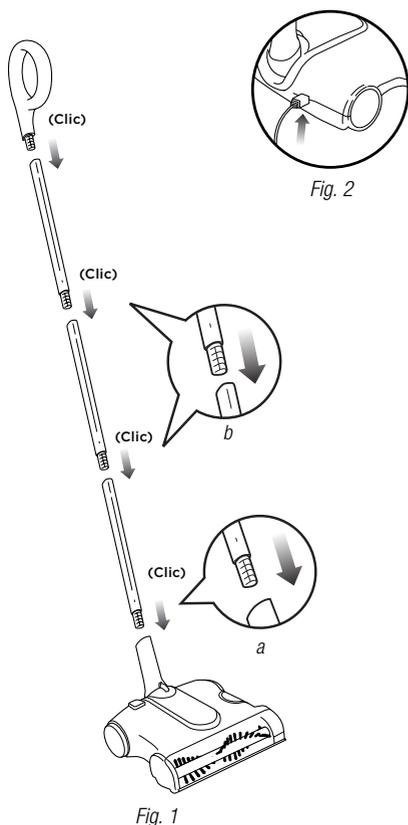
Insérez le tube de rallonge inférieur de la poignée (le plus court des trois tubes) dans le connecteur de la tête (a). Puis connectez les deux autres tubes de rallonge et insérez-les dans le tube de rallonge inférieur de la poignée (b). Fixez la poignée au tube supérieur. (Fig. 1)
