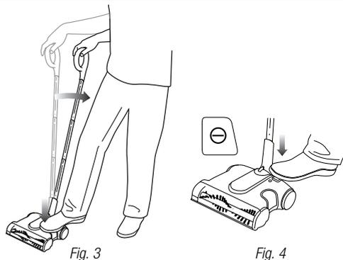
Pour activer la direction, appuyez légèrement sur la tête de la balayeuse et inclinez la poignée vers l'arrière. (Fig. 3)
