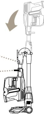
Appuyez sur le bouton MultiFLEX Lock Release (déverrouillage) et maintenez-le enfoncé tout en pliant l'aspirateur portatif vers l'avant jusqu'à ce qu'il se verrouille en mode de rangement.
