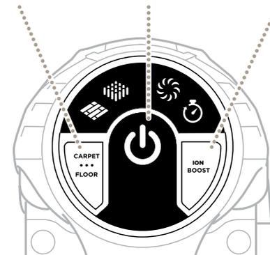
**REMARQUE :** Pour un nettoyage en profondeur selon la norme ASTM F 608 (saletés incrustées dans les tapis), veuillez choisir les réglages CARPET (tapis) et ION BOOST (stimulation aux ions).
