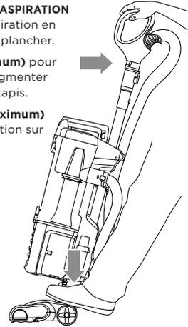
Pour activer la brosse rotative, appuyez sur la buse de plancher et inclinez la poignée vers l'arrière.
