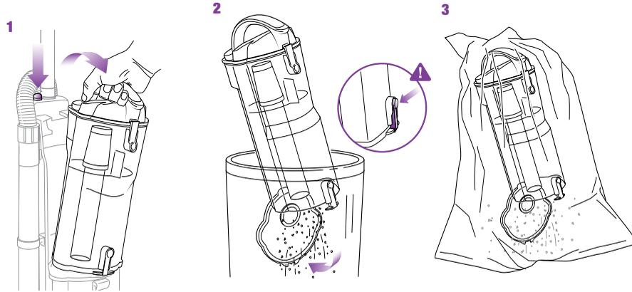
Pour des résultats optimaux, videz le récipient à poussière après chaque utilisation de l'aspirateur, à plusieurs reprises au cours d'un usage prolongé ou lorsque le niveau de poussière atteint la ligne de remplissage **MAX. VEILLEZ À NE JAMAIS REMPLIR EXCESSIVEMENT LA COUPELLE À POUSSIÈRE.** Mettez l'aspirateur en position verticale. Éteignez l'aspirateur.
