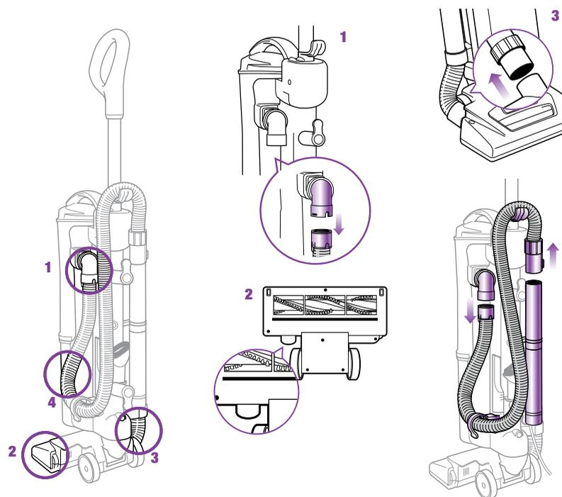
Les obstructions peuvent causer la surchauffe et l'arrêt automatique de l'aspirateur. Dans ce cas, délogez les obstructions, puis suivez les directives de la section Réinitialisation du thermostat du moteur à la page 23.
