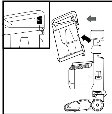
Pour retirer le **réceptacle à poussière**, appuyez sur le bouton de dégagement au-dessus du réceptacle. Inclinez le récipient à poussière en direction opposée du tube, puis soulevez-le afin de le retirer.
