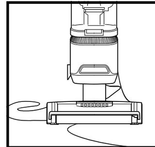
Pour minimiser le risque d'endommager le cordon d'alimentation, **NE PAS** faire passer l'aspirateur sur le cordon d'alimentation. Si cela se produit, coupez immédiatement l'alimentation de l'aspirateur et retirez le cordon de la brosse rotative ou de la buse.
