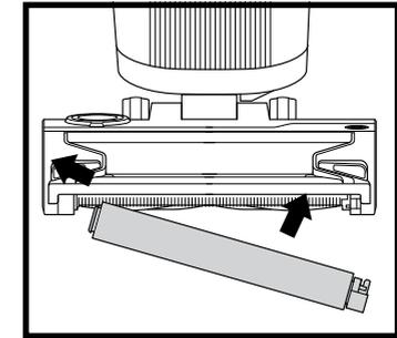
Lavez le rouleau doux à la main au besoin. Utilisez uniquement de l'eau et laissez-le sécher entièrement à l'air libre pendant au moins 24 heures. Réinsérez le rouleau doux à l'avant de la buse jusqu'à ce qu'un clic se fasse entendre.
