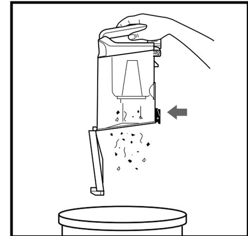
Pour vider les débris dans la poubelle, appuyez sur le bouton de dégagement inférieur pour ouvrir le bas du compartiment à poussière.
