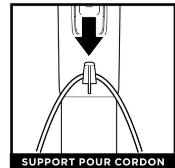
Utilisez le support pour cordon sur le côté du tube pour maintenir le cordon en place pendant l'aspiration.
