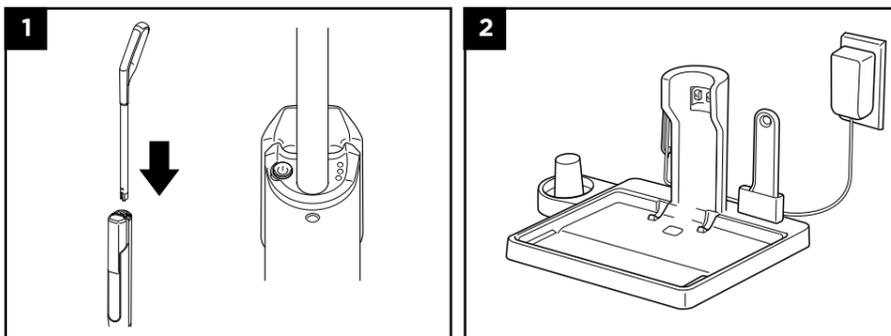
1. Alignez la tige avec l'ouverture du corps principal et insérez-la fermement jusqu'à ce qu'elle se fixe en place.
