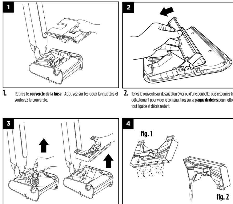
1. Retirez le **couvre-cil de la buse** : Appuyez sur les deux languettes et soulevez le couvercle.
