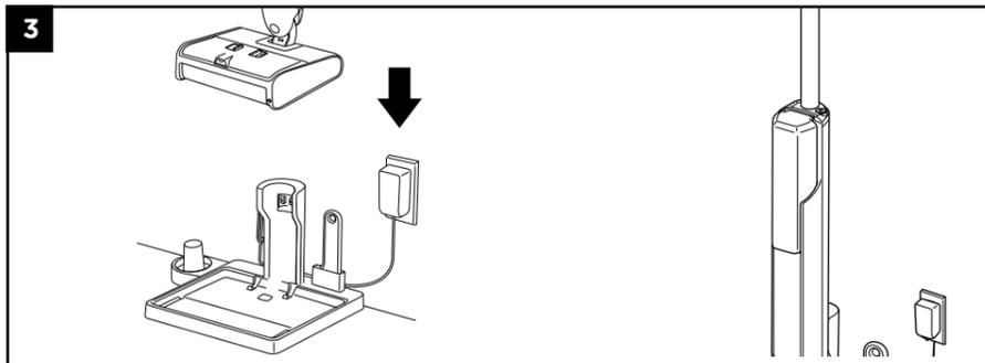
3. Chargez l'appareil en le plaçant sur la station de recharge. Assurez-vous que les contacts du corps de l'appareil sont alignés avec ceux de la station de recharge. Les voyants du corps principal s'allument lorsque la recharge est en cours.
