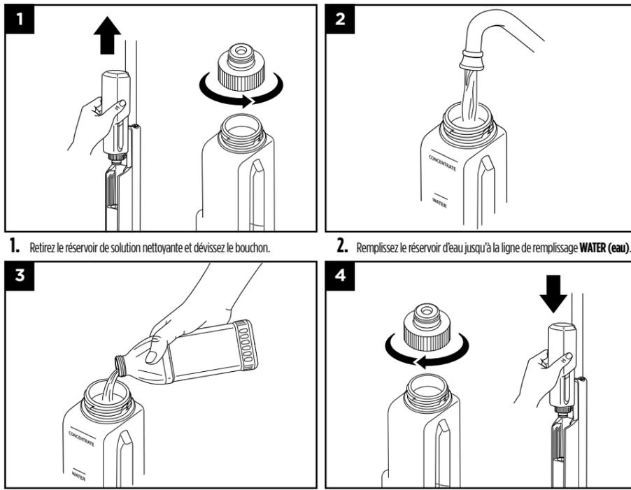
1. Retirez le réservoir de solution nettoyante et dévissez le bouchon.
