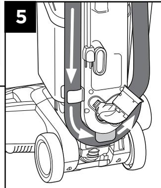
Enroulez le tuyau **fermement** autour de la languette inférieure.
