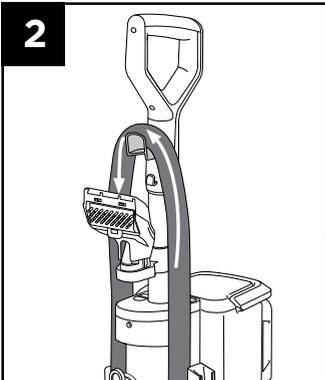
Enroulez le tuyau **fermement** autour de la languette supérieure.
