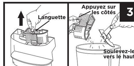
3. Pour retirer les poils et les cheveux du filtre, retirez-le du réservoir d'eau sale en soulevant sa languette. Tenez le filtre au-dessus d'une poubelle, appuyez sur les côtés inférieurs du panier du filtre et soulevez la languette. Tapotez le filtre doucement pour que les poils et les cheveux tombent dans la poubelle.
